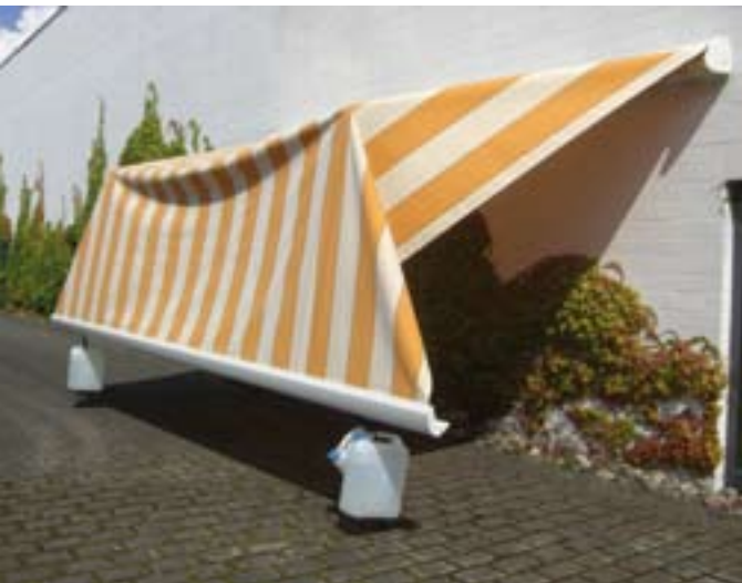
Kein Variovolant, sondern Materialversagen bei Windbelastung nach DIN EN 13561.
